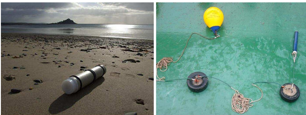
Bild 5.5: Foto eines C-PODs und des Verankerungssystems der C-PODs mit zwei Ankerblöcken und Fender.
