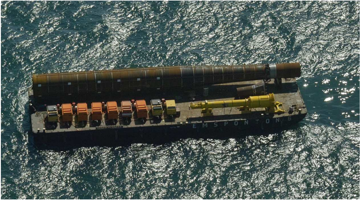
Bild 6.2: Seeponton mit Monopile, Rammbar und 9 Dieseldieseln.
