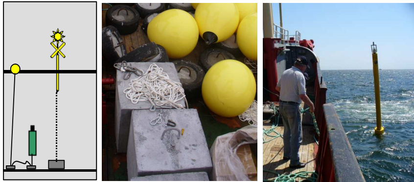
Bild 5.6: Schema des auf See ausgebrachten POD-Systems und Foto der für die Leuchtspiere verwendeten Ankersteine und der verankerten Leuchtspiere.
